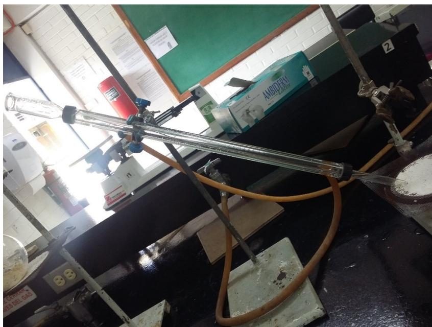
Condensador del sistema de arrastre de vapor.
