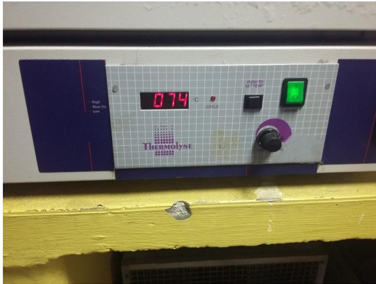
Horno para someter las soluciones a calor y extraer el agua presente en la misma.
