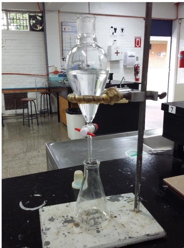
Solución de agua, aceite y éter en ampolla de decantación para su separación con sulfato de sodio anhidrido.
