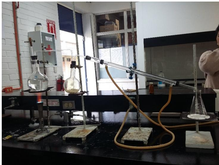
Equipo de arrastre de vapor armado con una fuente de calor permanente y controlada y conectada a dos fuentes de agua fijas.
