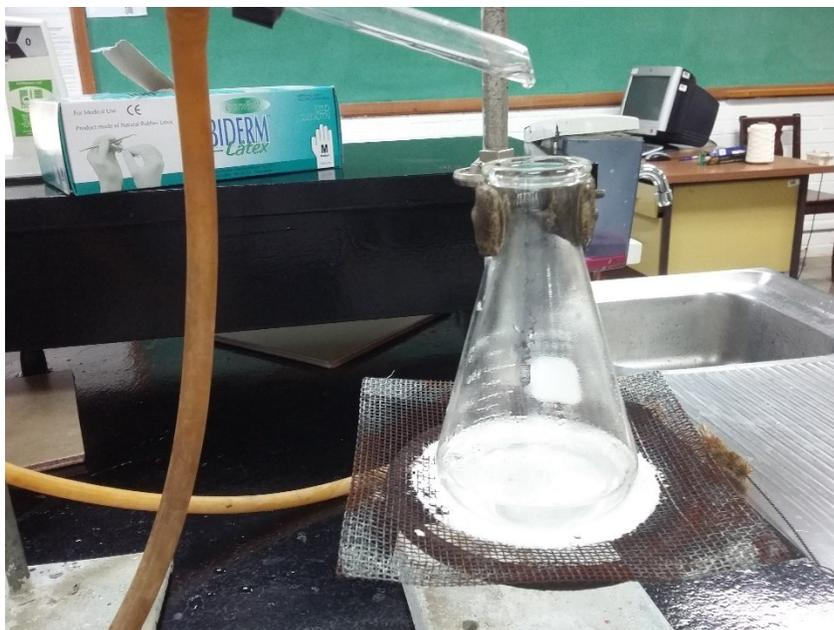
Beaker para la recepción de la solución de agua y aceite del sistema de arrastre de vapor.
