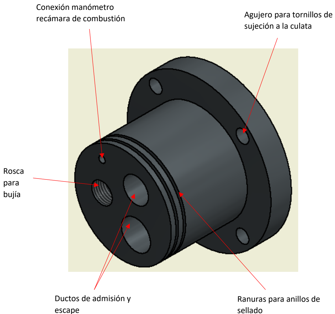
Ilustración 30 Contra-pistón diseño CAD.
