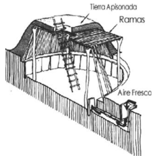
Fig. 7 Ejemplo esquemático de vivienda semienterrada.
