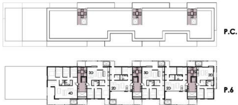
Fig. 53 Análisis de circulaciones verticales en el edificio (Circulaciones en morado).
