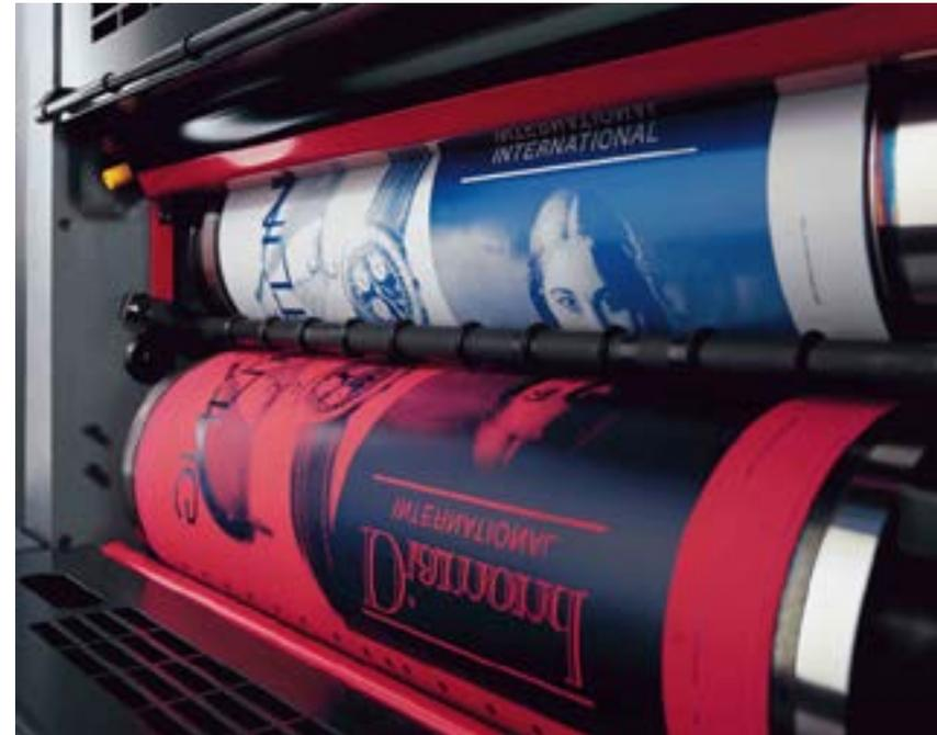
Imagen 90. Cilindros de litografía offset imprimiendo. Fuente: [goo.gl/RQZk11](https://goo.gl/RQZk11)
