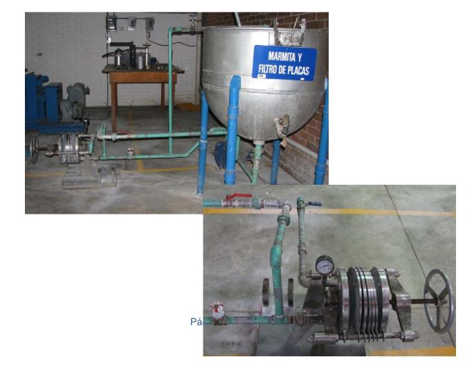
SISTEMA: SUSPENSIÓN DE CARBONATO DE CALICO (6 KG DE CARBONATO DE CALCIO EN 30 GALONES DE AGUA)
