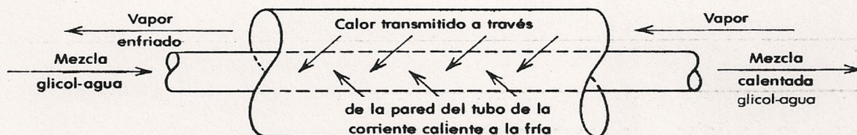
FIGURA 1.3 Diagrama esquemático de un intercambiador de calor.
