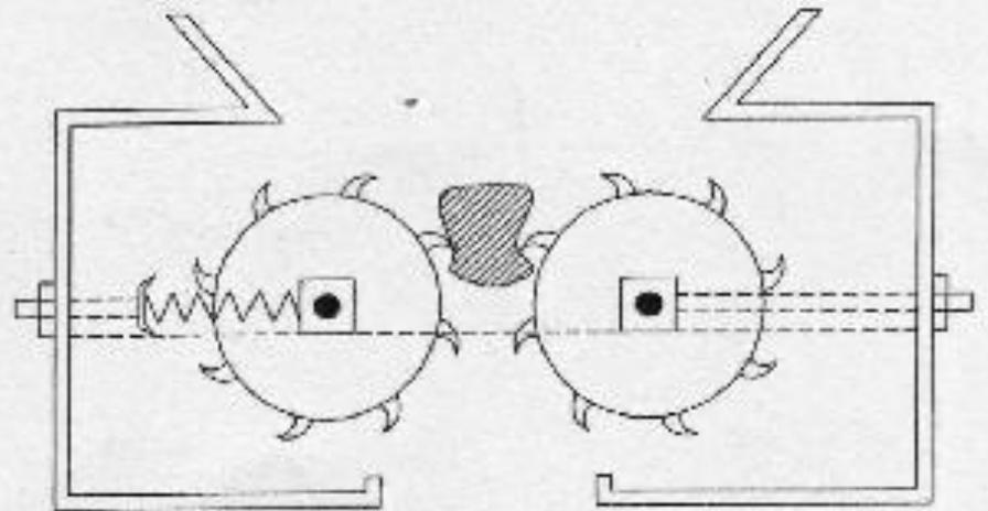
*Figura 18. Trituradora de dos cilindros dentados.*
