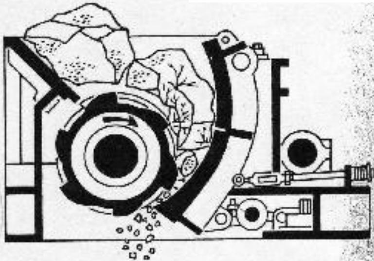
*Figura 17. Triturador de cilindro dentado y placa.*
