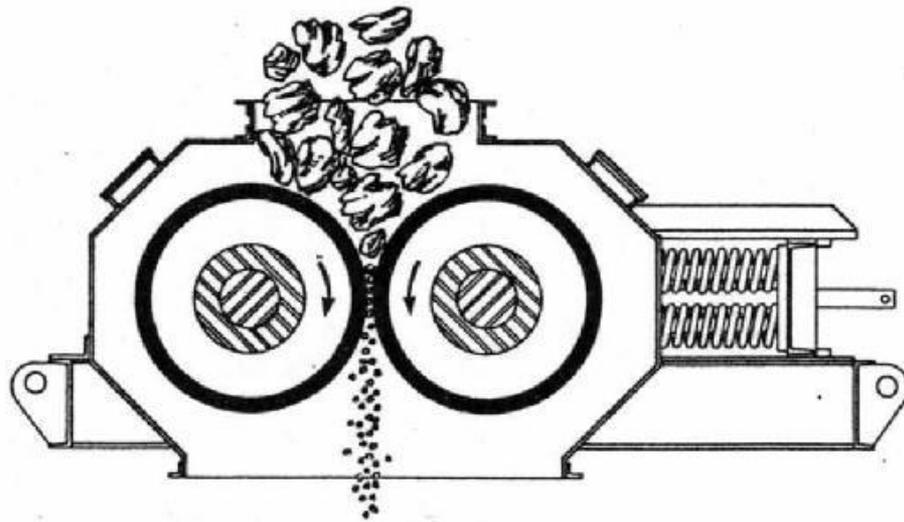
*Figura 16. Triturador de cilindros lisos.*
