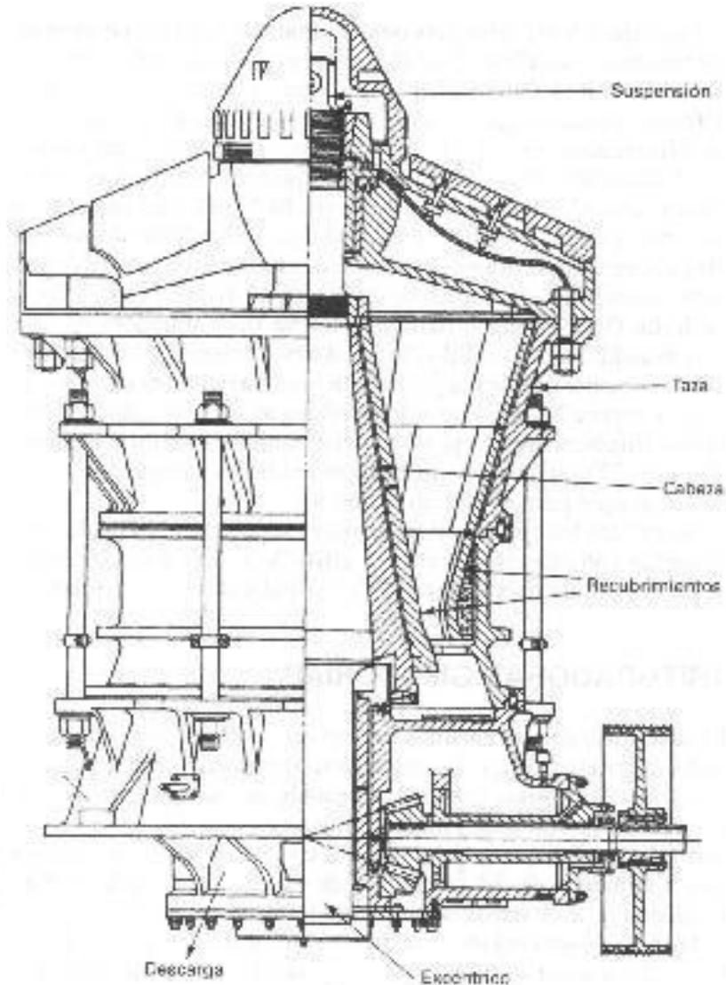
FIG. 20.23. Trituradora giratoria primaria con suspensión de araña. (Nordberg, Inc.)
