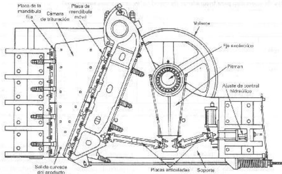
FIG. 20.22. Trituradora de mandíbula tipo Blake. (Allis Mineral Systems Grinding Div., Svedala Industries, Inc.)
