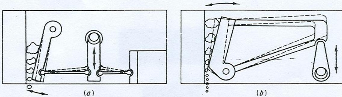
Fig. 17.4 Quebrantadoras de mandíbulas. (a) Quebrantadora Blake de doble palanca; (b) quebrantadora Dodge. (Tomado con autorización de la obra de D. M. Liddell, "Handbook of Nonferrous Metallurgy", McGraw-Hill Book Company, Inc., Nueva York, 1945.)
