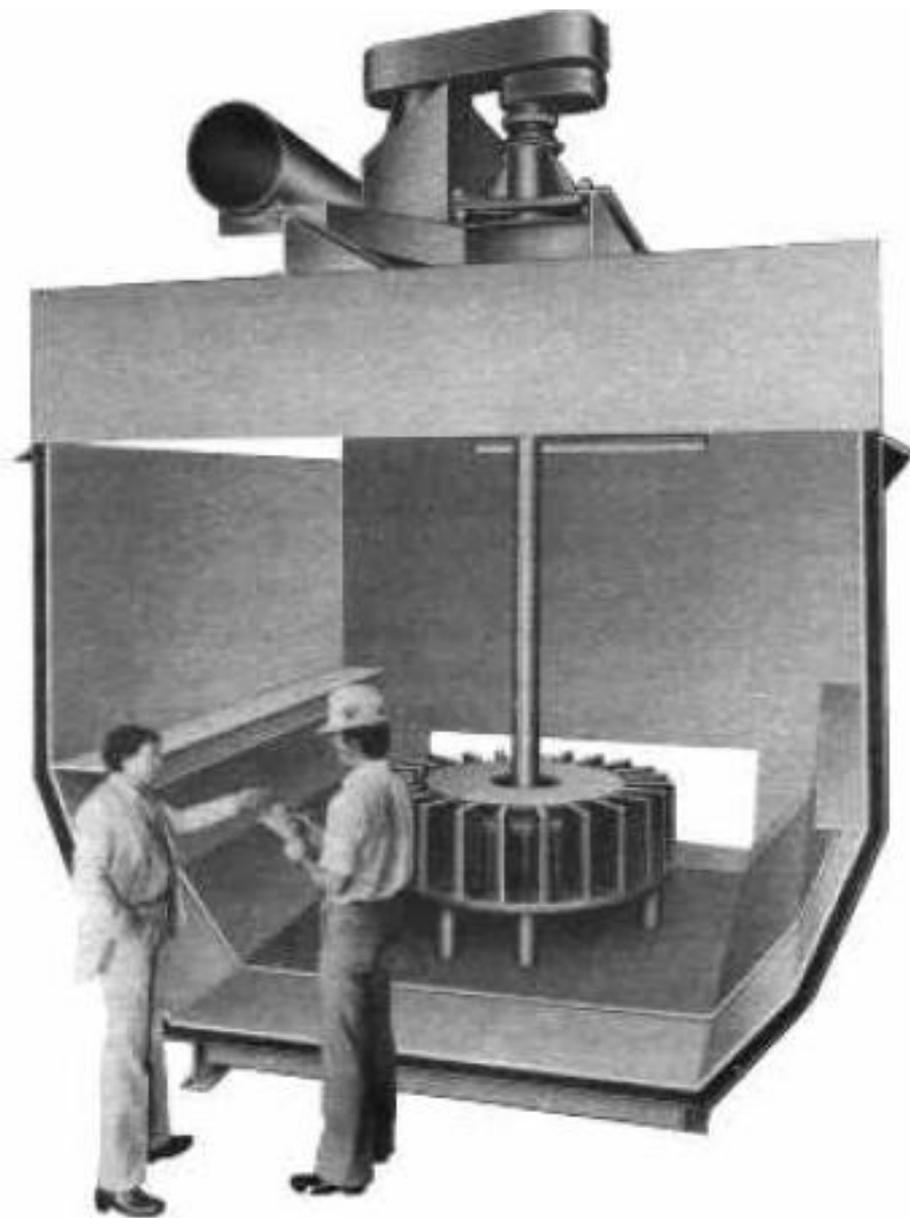
Fig. N° 14. Celdas de flotación de 42.5 m<sup>3</sup>.
