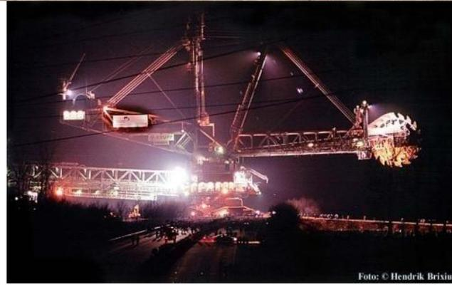
**Con una longitud de 240 metros, una altura de 96 metros y un peso de 13.500 toneladas, la Bagger 288 es el vehículo terrestre móvil más grande del mundo. La Bagger es una excavadora pensada para minería del carbón, puede producir 2.400 vagonetas de mineral al día**
